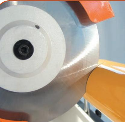
a la bobina para cortar. La cuchilla se lubrifica con un sistema atomizador para evitar que el adhesivo se adhiera a la misma. El atomizador se controla con un botón desde el mismo mango de corte.
