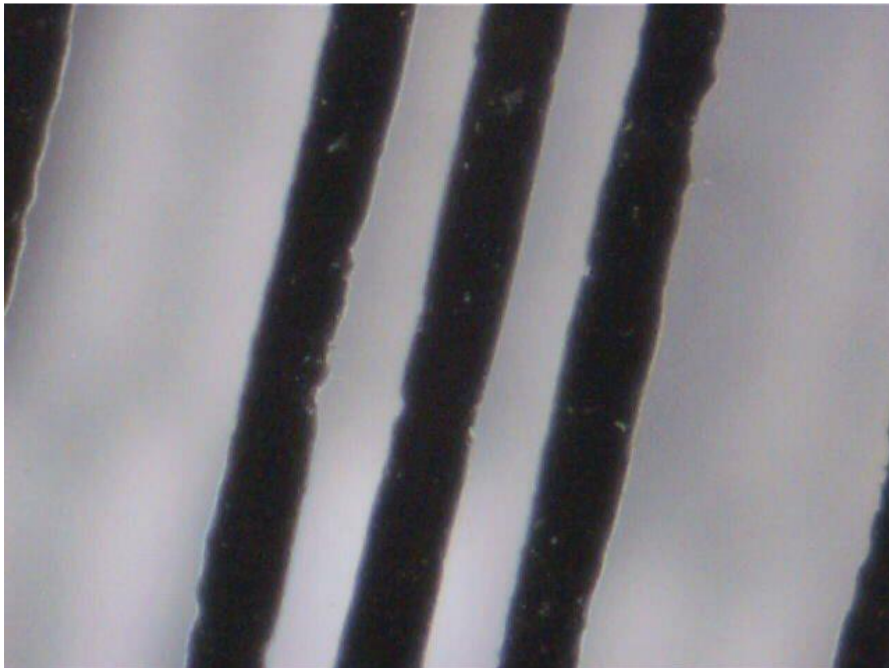
Εκτυπωτικό αποτέλεσμα με EOM 7 microns και τιμή Rz 5 microns. Μεγέθυνση 140 φορές
