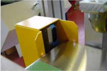
Abb. 5: Lichttaster (Vorabschaltpunkt) im Bereich der Vorzentrierung
