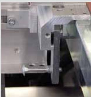
Abb. 11: Anschlag für den Siebrahmen
