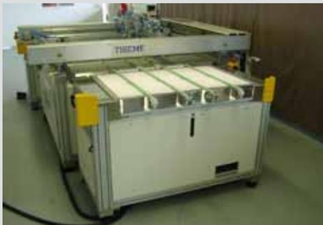
Abb. 17: Maschinenauslauf mit integriertem Leuchttisch (Option)
