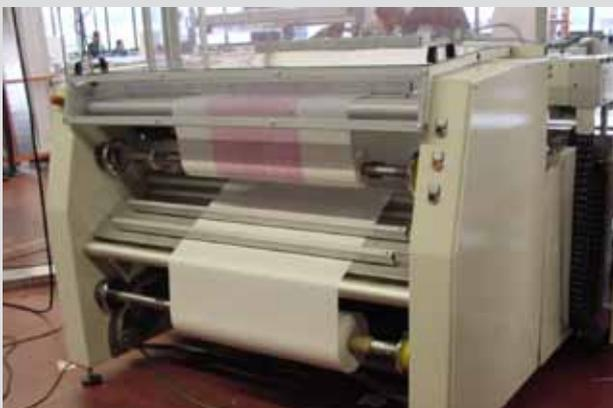
Abb. 21: CleanPrint Einrichtung (Rückseite der Maschine)
