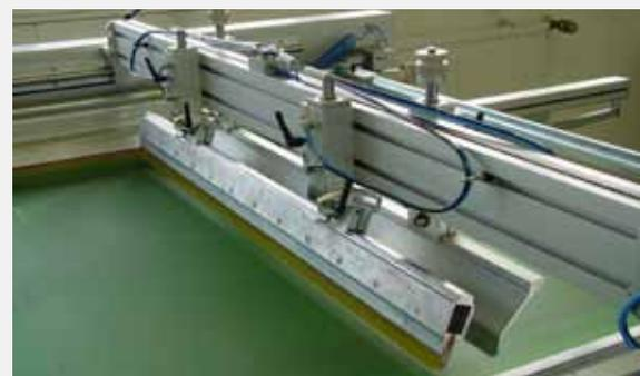
Die als Option erhältliche 90° Rakelschwenk-Vorrichtung mit integrierter Abtropfrinne erleichtert den Rakelwechsel. Dabei befindet sich die Abtropfrinne immer direkt am Sieb.
