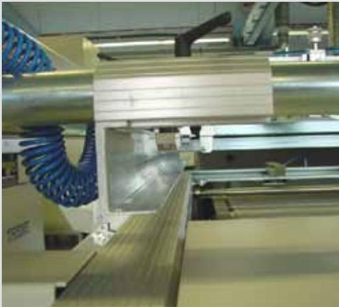
Abb. 9: Verstellbare Siebauflegeschiene
