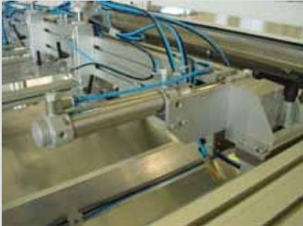
Abb. 14: Optionale 90° Rakelschwenk-Vorrichtung
