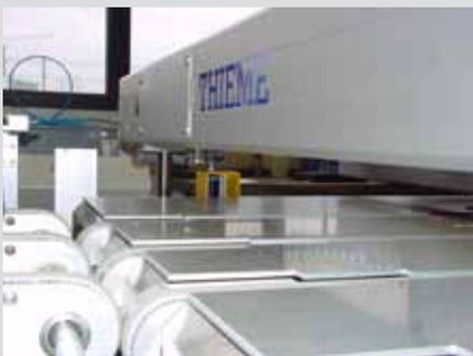
Abb. 7: Lichtschranke (Abschaltpunkt) im Bereich des Drucktisches
