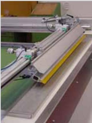
Abb. 4: Optionale 90° Rakelschwenk-Vorrichtung
