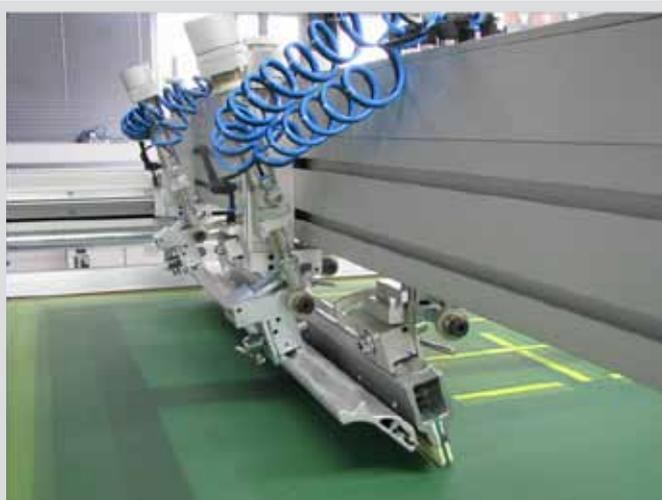
Abb. 17: Antitropfeinrichtung beim Drucken-
