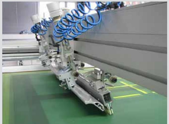
Abb. 11: Antitropfeinrichtung beim Drucken
