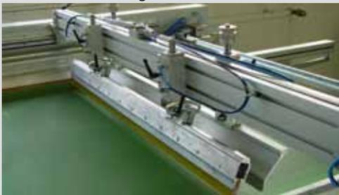
Pneumatisch gesteuerte Rakelzylinder sind anstelle der bisher üblichen Rakelträger-Balken am THIEME-Leichtmetallträger stufenlos verstellbar angebracht. Die Verteilung des Rakel-druckes kann optimal eingerichtet werden, und die unerwünschte Durchbiegung der Rakel wird daher weitgehend vermieden. Der eingestellte Rakeldruck wird durch die reibungsarme Kugelführung der Umschaltknöpfe, welche die Rakelhubbewegung ausführen, auch unter Belastung feinfühlig konstant gehalten.
