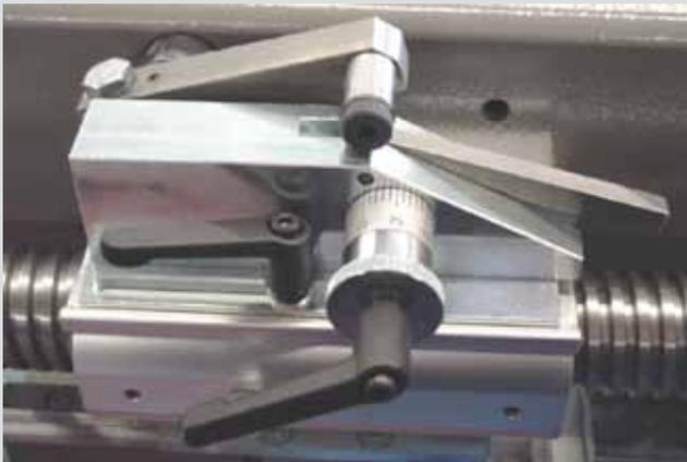
Sieblifhöhe und Ort des Einsatzes werden in Abhängigkeit von Siebspannung und Farbviskosität auf einfache Weise über den gesamten Rakelweg eingestellt, um den vielfältigen Aufgaben im Siebdruck gerecht zu werden. Die Sieblifhöhe sowie der Sieblifteinsatzpunkt sind stufenlos einstellbar von 0 bis 4 mm, bezogen auf 200 mm Rakelweg. Das Sieb wird in die horizontale Lage zurückgesetzt bevor der Flutvorgang startet.
