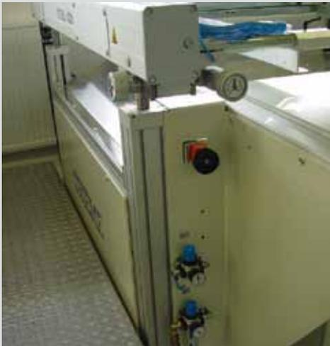
Auf der Rückseite liegt der Mutterrahmen auf einer Traverse auf. Die Verbindung zu dieser Traverse bildet eine pneumatische Klemmvorrichtung, die zur Feineinstellung des Siebrahmens vom Bedienpult aus geöffnet und geschlossen werden kann. Unnötige Wege um die Maschine werden dadurch vermieden.
