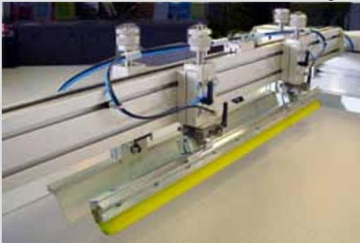
Abb. 3: THIEME-Rakelwerk (patentiert)
